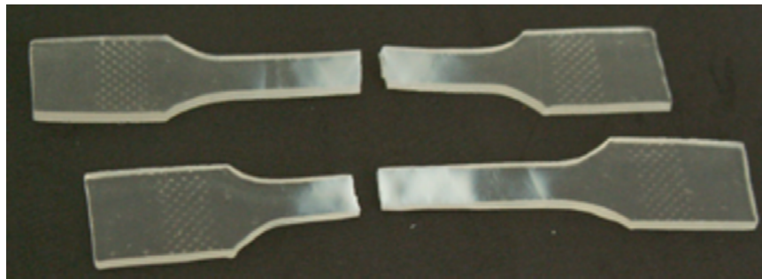
Abbildung 3.73: Scherbänder - Zerstörte Probekörper von Blend 182c
