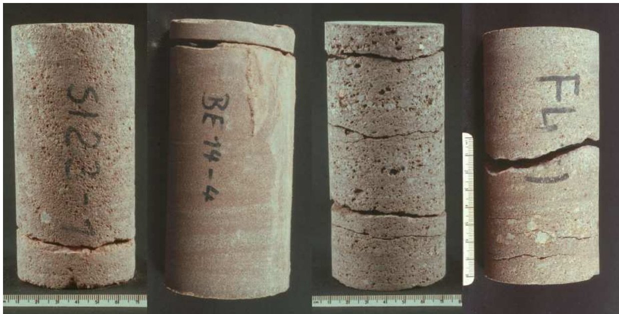
Abb. 26: Deformationsmuster der im triaxialen Extensionsversuch erzeugten Trennbrüche der verschiedenen Lithotypen in den angewendeten Versuchsmodi (s.a. Abb. 27 bis 29):
