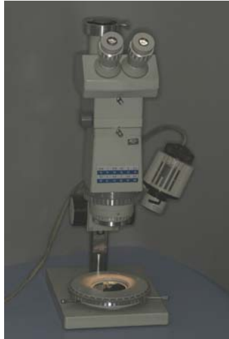
Abb. 11: Stereoauflichtmikroskop der Firma „VEB Carl Zeiss, Jena“
