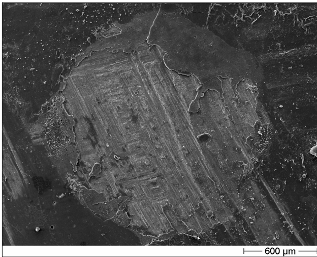
Abbildung 45: Inhomogener Bruch (50x)
