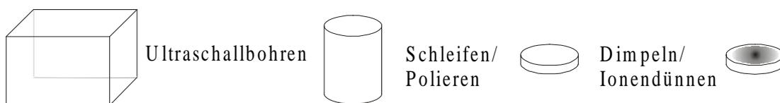
Abb. 77 Probenvorbereitung für die Elektronenmikroskopie
