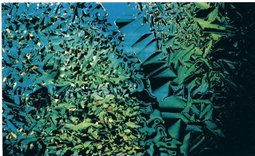
Abbildung 7-2 Fotografische Aufnahme des Kontaktbereiches zwischen 2,5-Bis(4-octyloxyphenyl)-1,3,4-thiadiazol VII und TNF bei 193 °C (abnehmender TNF-Gehalt von links nach rechts; Phasenfolge  $S_C/N/S_A/is$ ) (gekreuzte Polarisatoren)
