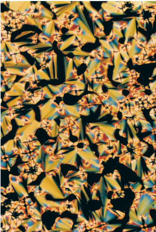
Abbildung 3-2 Textur der flüssigkristallinen Phase von BPEO4BTEO4 (1b) bei 98 °C (gekreuzte Polarisatoren)
