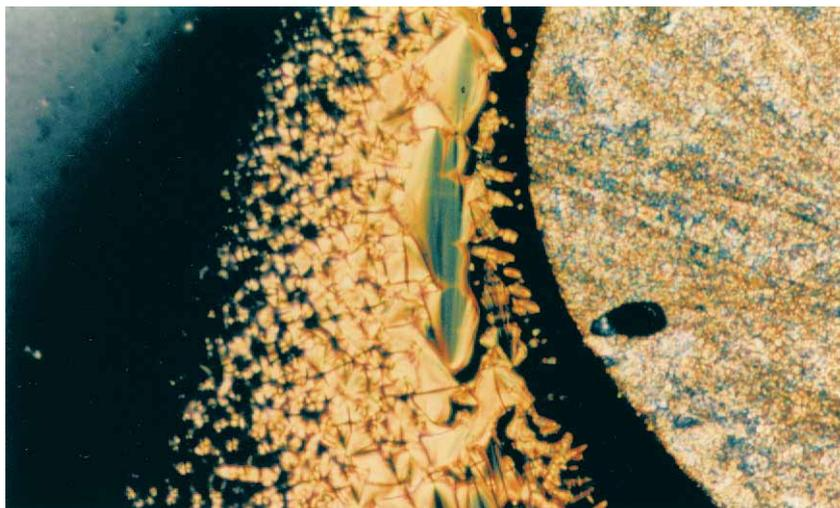
**Abbildung 4-10** Fotografische Aufnahme des Kontaktbereiches zwischen Verbindung **27** und TNF bei 120 °C (abnehmender TNF-Gehalt von links nach rechts; Phasenfolge N/S<sub>A</sub>/is/cr) (gekreuzte Polarisatoren)
