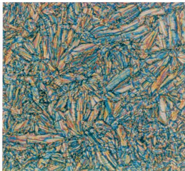
Abbildung 4-6 Textur der flüssigkristallinen Phase von *DPTMEO4TPEO4M* bei 150 °C (gekreuzte Polarisatoren)
