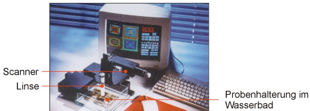
Abbildung 8: Das akustische Rastermikroskop KSI SAM 100
