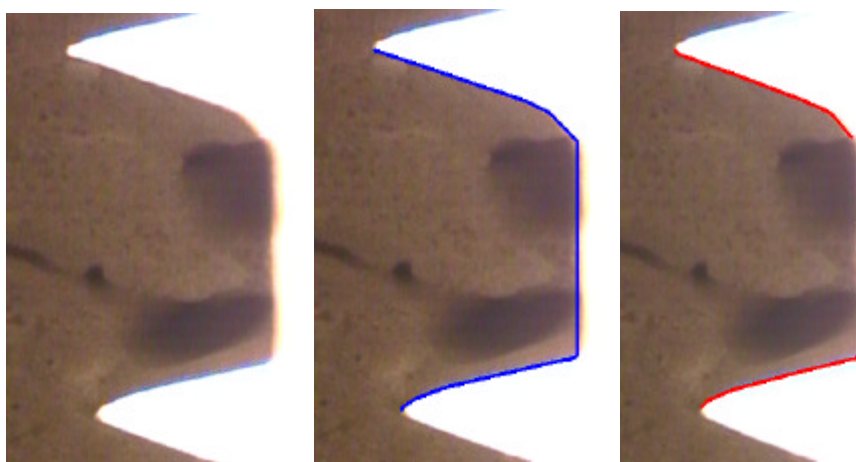
Abb.10: Messung des Schrauben-Knochenkontakts in den mikroradiographischen Bilder (links) das Metall wurde herausgelöst, die Schraubenwindung erscheint daher weiß. Zunächst wurde die Gesamtlänge des Windungsprofils vermessen (Mitte, blau markierter Bereich), danach der Teil der Schraubenwindung, dem der Knochen unmittelbar anliegt (rechts, rot markiert). Die Länge der Schraubenwindung, die direkten Kontakt zum Knochen hatte, wurde dann in Prozent der Gesamtlänge der Schraubenwindung berechnet.
