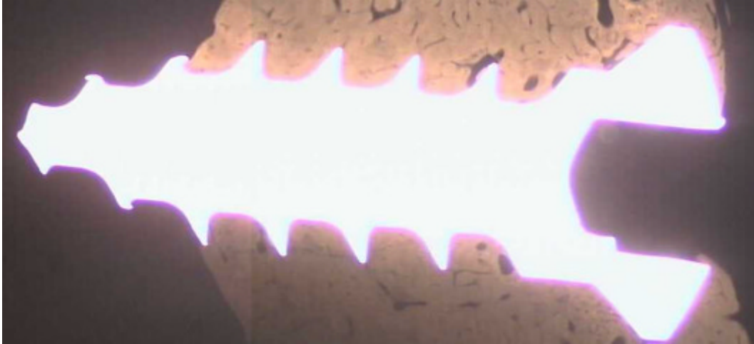
Abb.25: Mikroradiographisches Bild (10-fache Vergrößerung) einer Drill-Free-Minischraube, die Schraubenspitze hat den Knochen perforiert, insgesamt 8 Schraubenwindungen sind vollständig von Knochen bedeckt und für die Untersuchungen verwendbar.
