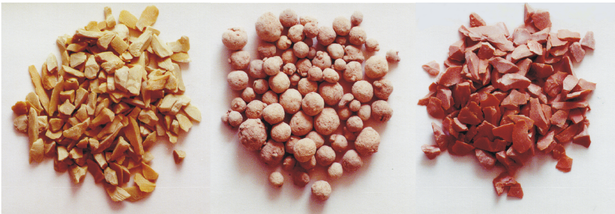
Pb_3ZrTiO_8 (PK 51) BaSrTiO_4 (BST 911) BaTiO_3 Korngröße: 2,0-2,5 mm Korngröße: 2,0-5,0 mm Korngröße: 2,5-3,0 mm
