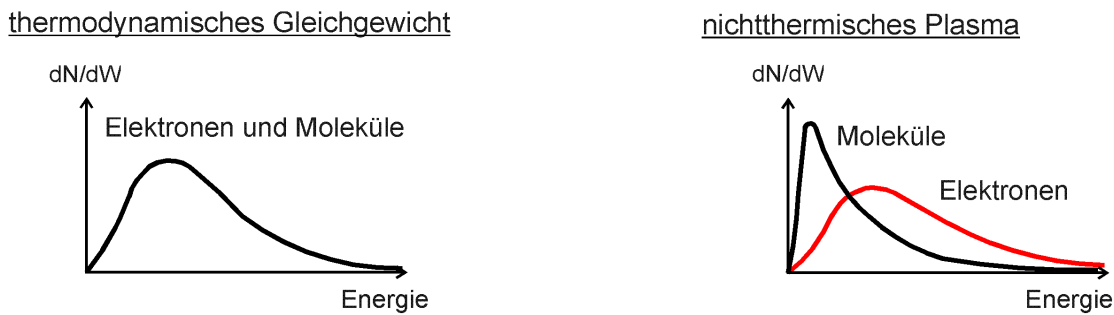
Abbildung II.1: Energieverteilung im thermodynamischen Gleichgewicht und im NTP
