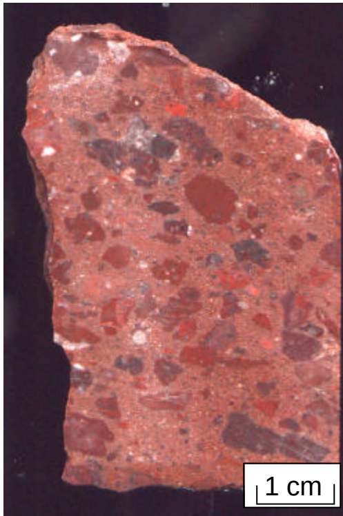
Abb. 4-12: Feinkörniges, matrixgestütztes Rotliegend-Konglomerat (Probe Mi10; Bohrung Mirow 1/74)
