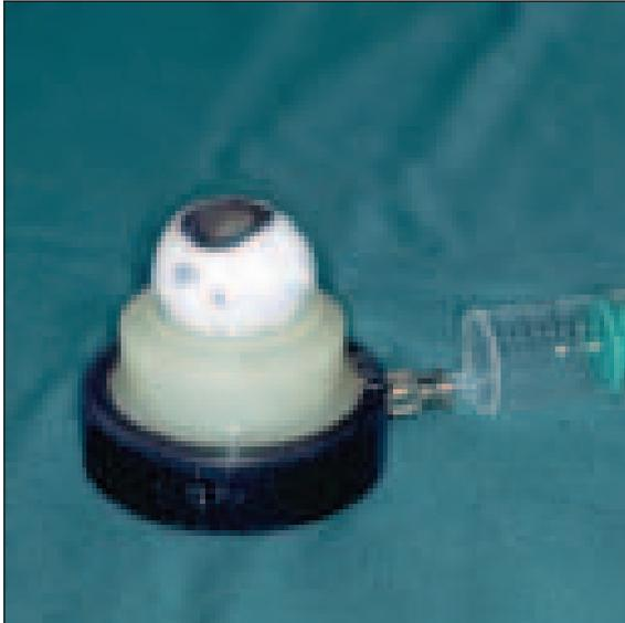
Abb. 5: Versuchsanordnung mit dem im Bulbushalter nach Spitznas fixierten Schweineauge [93]
