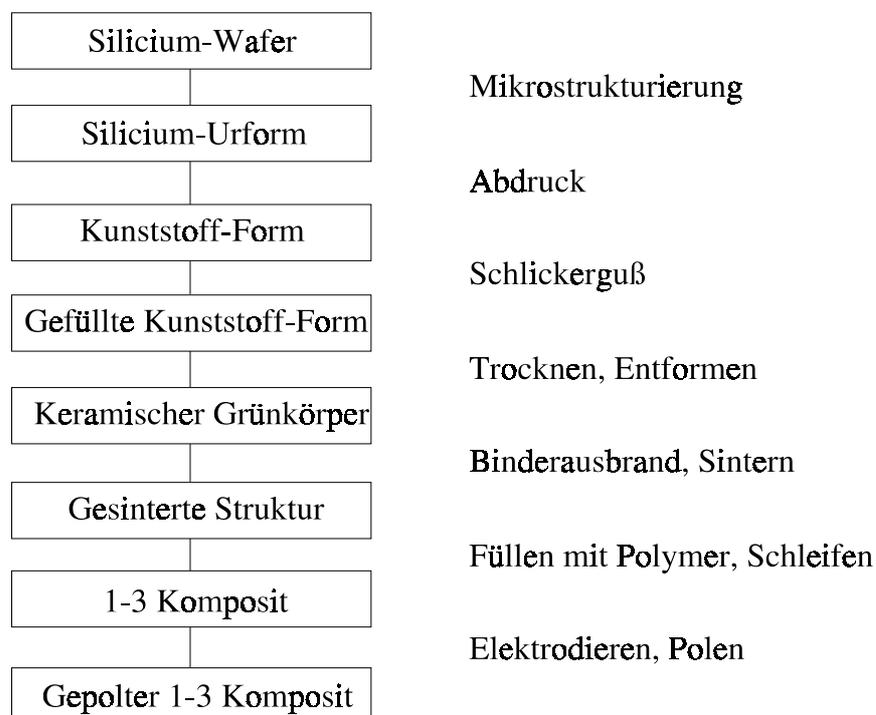
**Abb. 2.1** Schematischer Ablauf des Schlickerguß-Verfahrens zur Herstellung von 1-3 Kompositen
