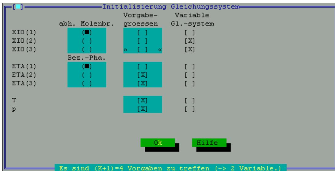
Abb. 8.9: Initialisierung der Gleichgewichtsberechnung in POLMEPHA am Beispiel eines ternären Dreiphasengleichgewichts.
