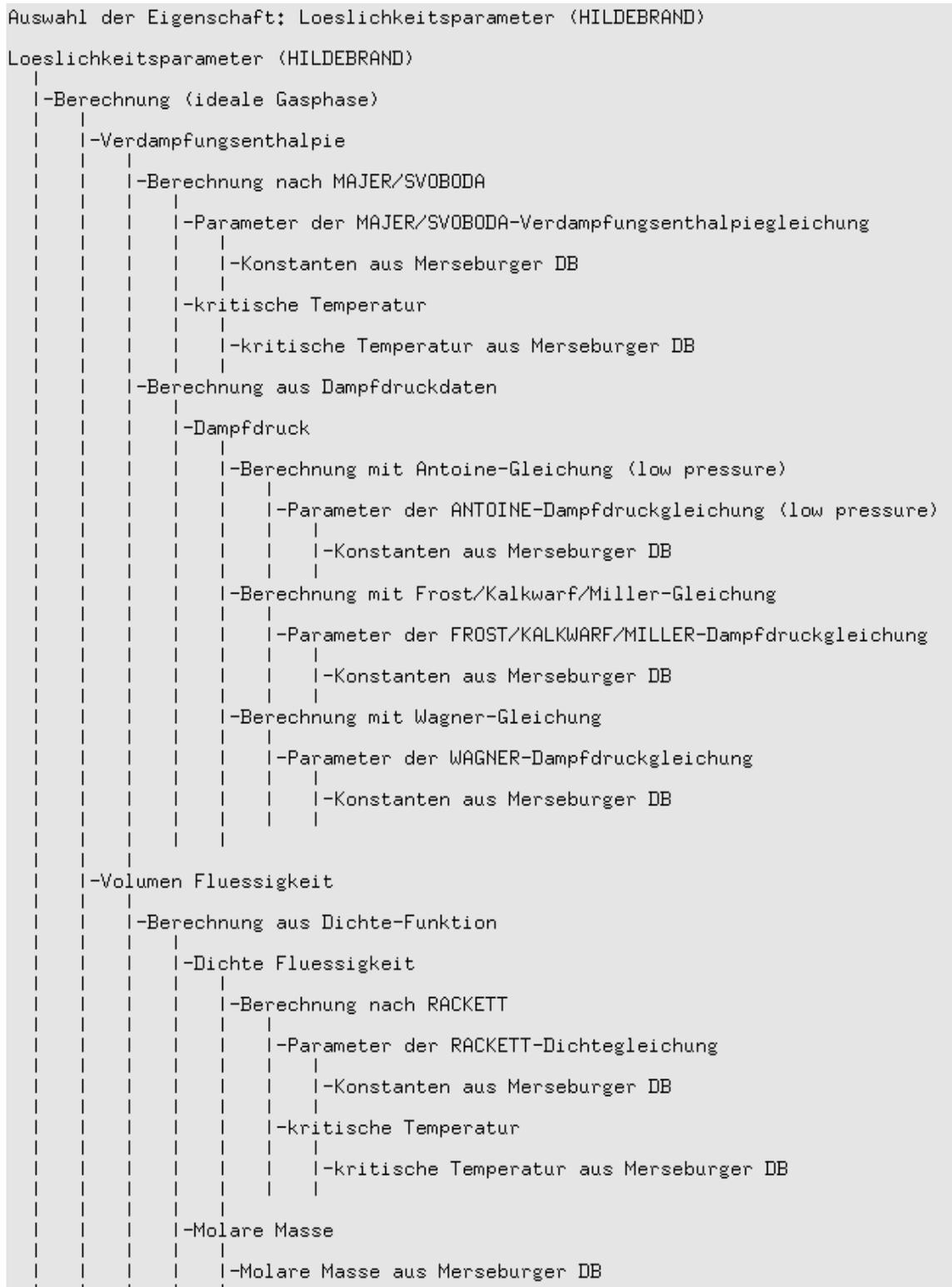
**Abb. 8.5:** POLPERT-Darstellung eines Ausschnittes des Lösungsraums für die Datenbereitstellung am Beispiel des HILDEBRANDSchen Löslichkeitsparameters.
