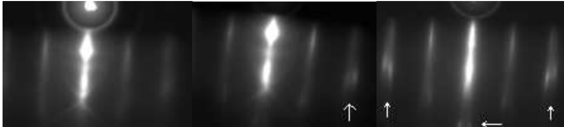
Abbildung 3-14: RHEED – Beugungsbilder in Fe[100] – Richtung mit 4,5 (links), 5,5 (Mitte) und 9 (rechts) Monolagen MgO. Die Pfeile zeigen auf die gesplitteten Reflexe.
