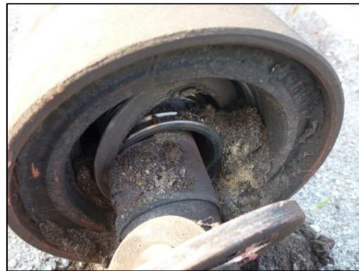
Bild 5: Folgeschaden an einer Tragrolle des Herstellers A in Form eines komplett zerstörten Wälzlagers, der Innenring hat sich schon mehrere Millimeter in die Tragrollenachse eingearbeitet [LEAG]
