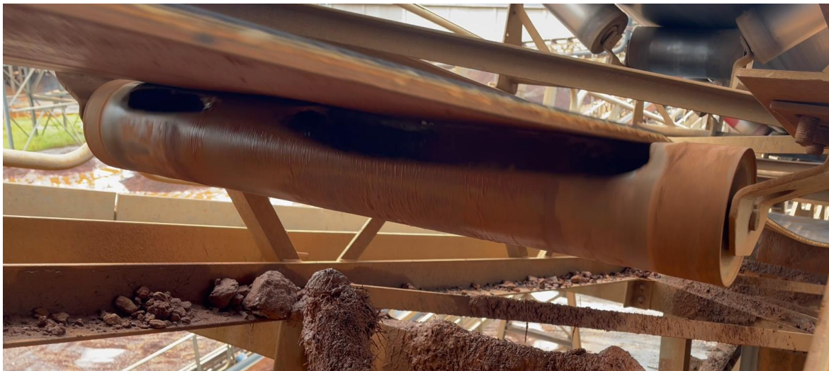
Bild 2: Verschleiß an der Untergurtrolle durch Carryback
