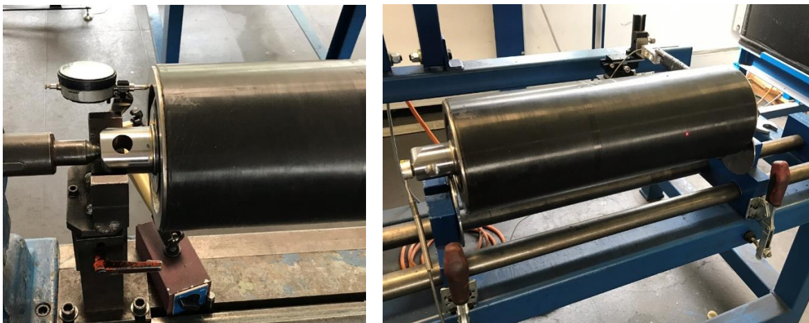
Bild 4: xForce-Composite-Tragrolle in den Prüfständen Planlaufmessung (links), Laufwiderstands- und Temperaturmessung (rechts)
