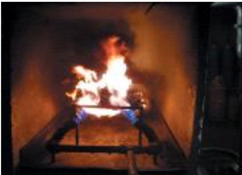
Bild 6: Die Klasse 4A erfordert zusätzlich zur Prüfung nach EN/ISO 340 die Prüfung nach EN12881-1 Methode A, C oder D.
