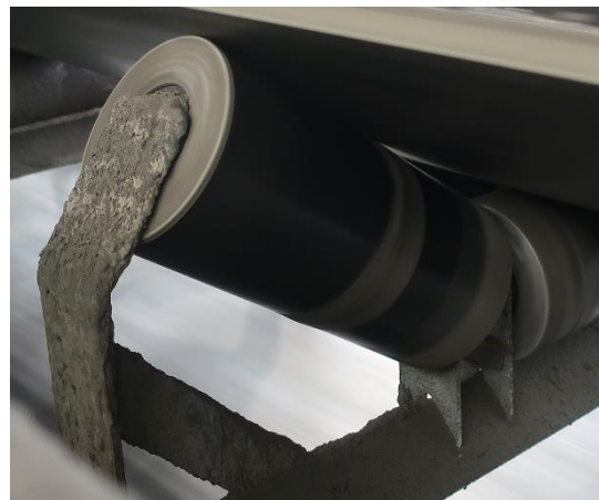
Bild 8: Selbstreinigende Manteloberfläche der xForce-Tragrolle
