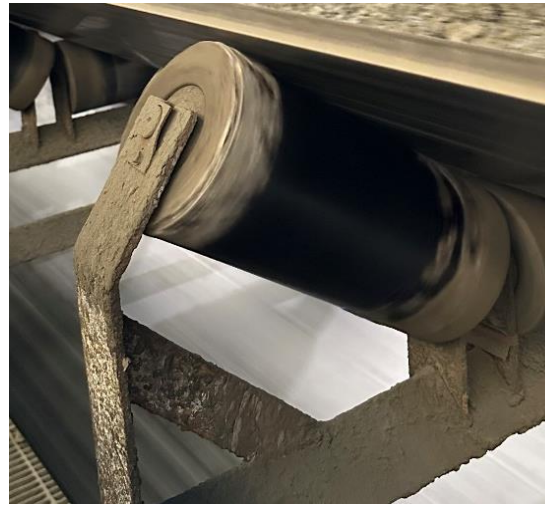
Bild 10: Tragrollenzustand im Mai 2023 nach 4,5 Jahren im Dauerbetrieb
