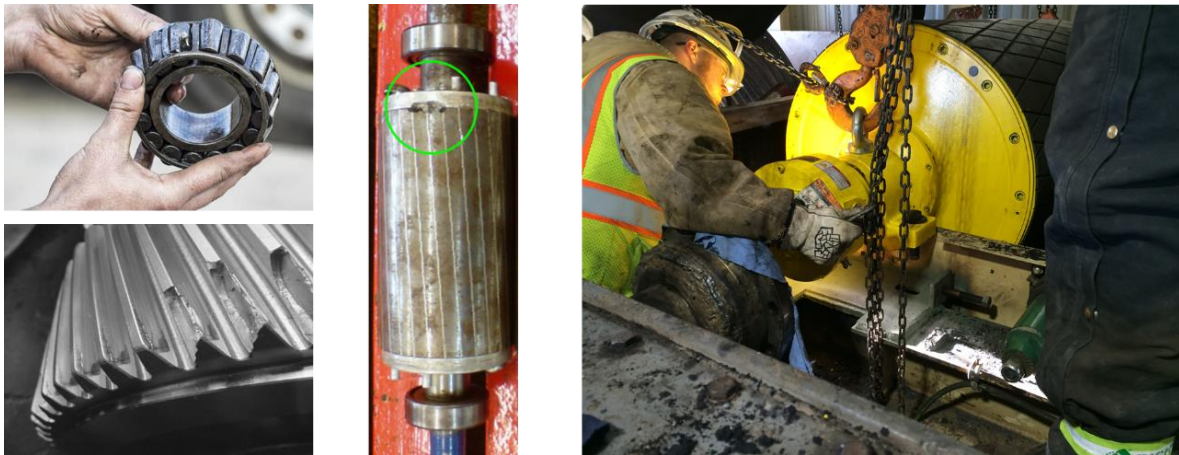
Bild 9 bis 12: Klassische Schäden an Trommelmotoren durch Überlastung
