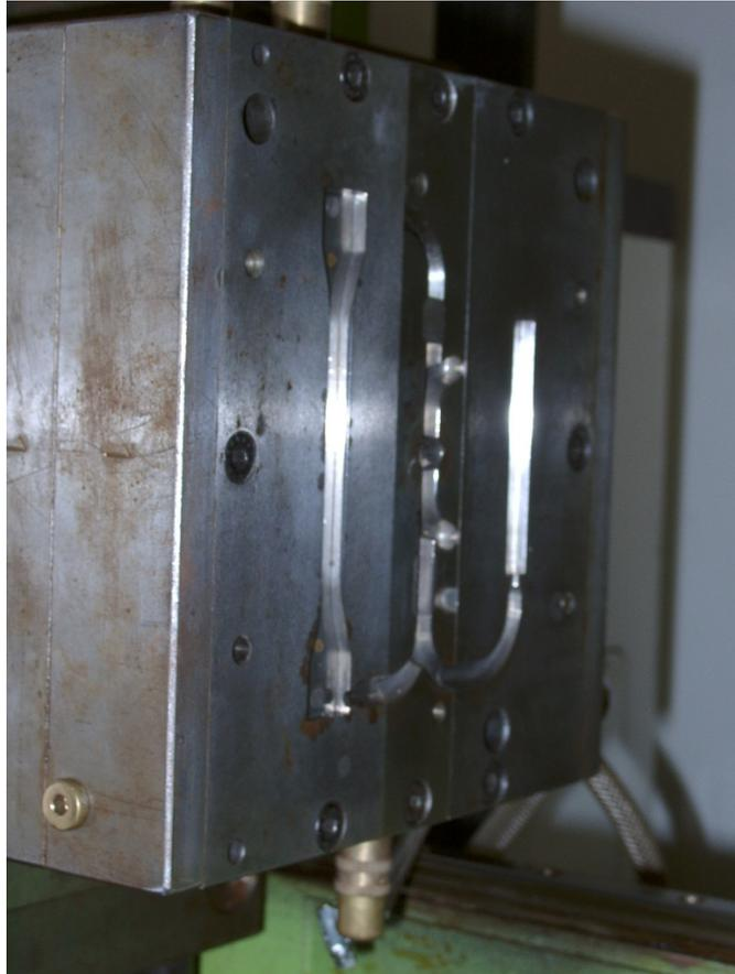
**Bild 31 Für den Vergleichsprozess verwendetes Spritzgusswerkzeug**
