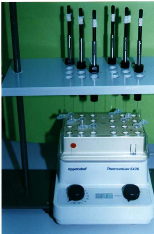
Abb. 2 SPME-Apparatur zur simultanen Probenextraktion.
